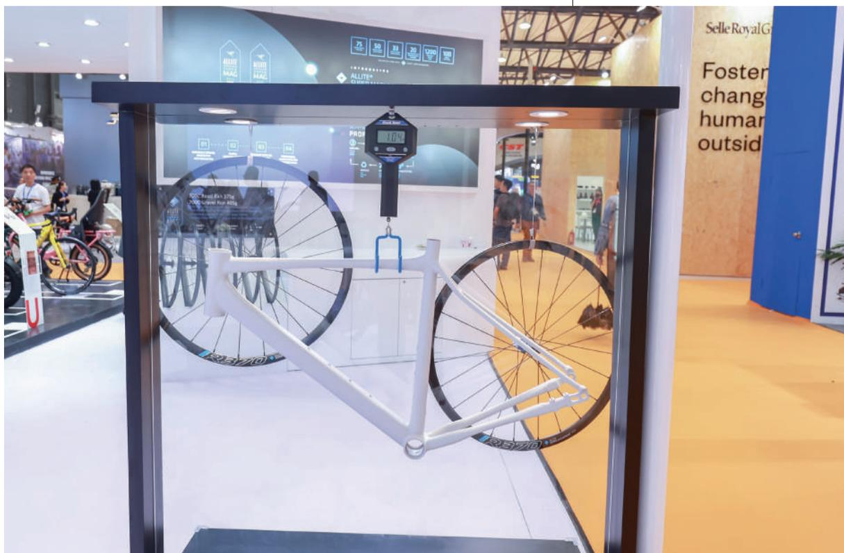
镁合金比铝合金轻 1/3，同体积下镁合金金属锭只有 418 g。据 ALLITE 工作人员介绍，目前铝合金碟刹车架通常质量（重量）为 1 200 g 左右，这一质量 VAAST 初代公路车 R/1 已经达到了，后面将向 900 g 的理论极限质量发起冲击。
