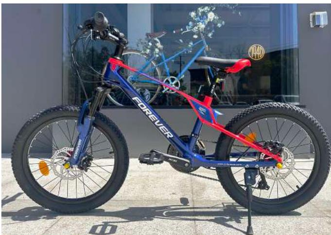
该车以经典红蓝色为灵感，造型前沿，车身专为青少年打造，专业的配置兼顾实用与造型；车架采用镁合金一体成型车架，内走线设计，具有轻量化的特点，通过 50 000 次振动测试，为骑行者打造轻便、健康、舒适的骑行体验；个性贴花 LOGO 图案采用德国经典设备烤漆，光滑耐腐蚀，彰显个性，青春飞扬；搭配禧玛诺 21 速变速器，使青少年在骑行时能流畅换挡；短距刹把，保障了骑行的安全性和可靠性；采用培林花鼓，低滚阻，使骑行更顺滑，使用寿命更长；浩盟铝曲柄牙盘，质量（重量）轻，强度高，在青少年高强度冲刺的情况下，也能高效输出，让骑行者放心奔放骑行。
