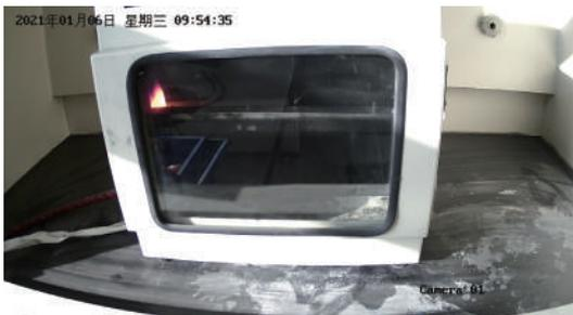
图 1 火焰 15 s 燃烧断气后样条燃烧情况
