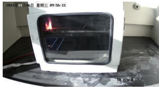
图 2 燃烧约 2 min 后火焰燃烧至第一标线
