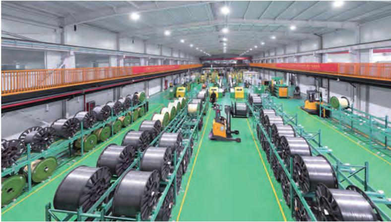
贝肯霍夫自主研发的berAlweld<sup>®</sup> 4043 铝合金焊丝，其中的硅元素与微量元素完美熔合，增强了流动性，降低了裂纹敏感性，提升了焊缝的亮度，焊接自行车车架堪称完美。
