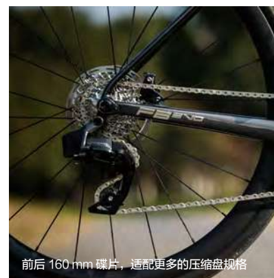
前后轮采用 38C 框高碳轮，搭配 28C 光圈胖胎，预留后期升级空间
