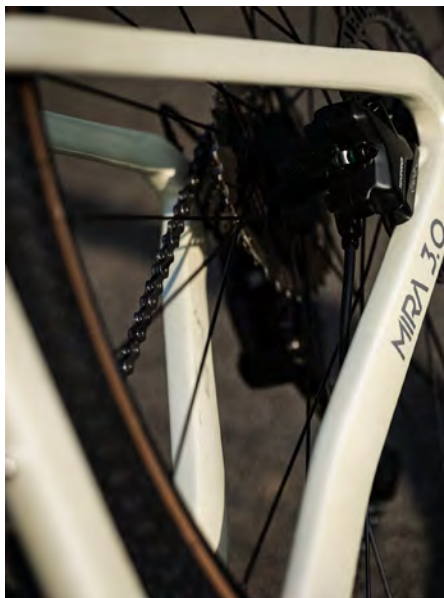
MIRA 3.0 搭配隐藏式走线油碟，后下叉采用内收异型管设计，有效减震
