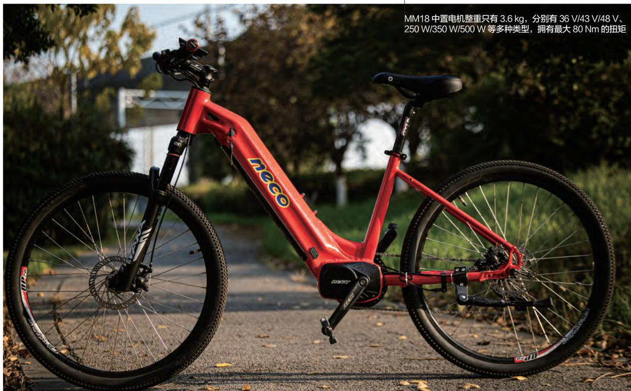
MM18 中置电机整重只有 3.6 kg，分别有 36 V/43 V/48 V、250 W/350 W/500 W 等多种类型，拥有最大 80 Nm 的扭矩
