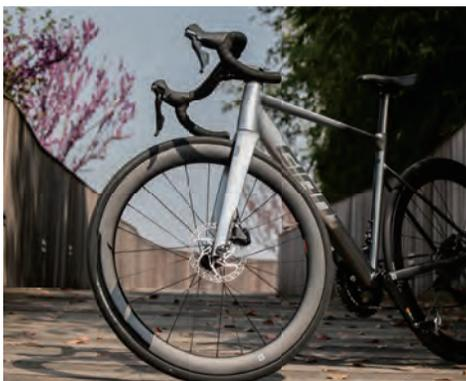
“大车适合高个子”的传统观念。此外，该车型配备的 -6° Contact SL 一体式铝合金把立，并未采用破风设计，其 28.6 mm 的管径与传统小圆把相似，握感尤为出色。
