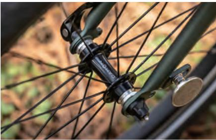
(左下) ARCHER P8 整车搭配前开挡 74 mm、后开挡 135 mm 的高强度铝轮组, 配备快拆结构的前二后四培林花鼓, 舒畅润滑, 从而确保加速灵敏、巡航稳定
