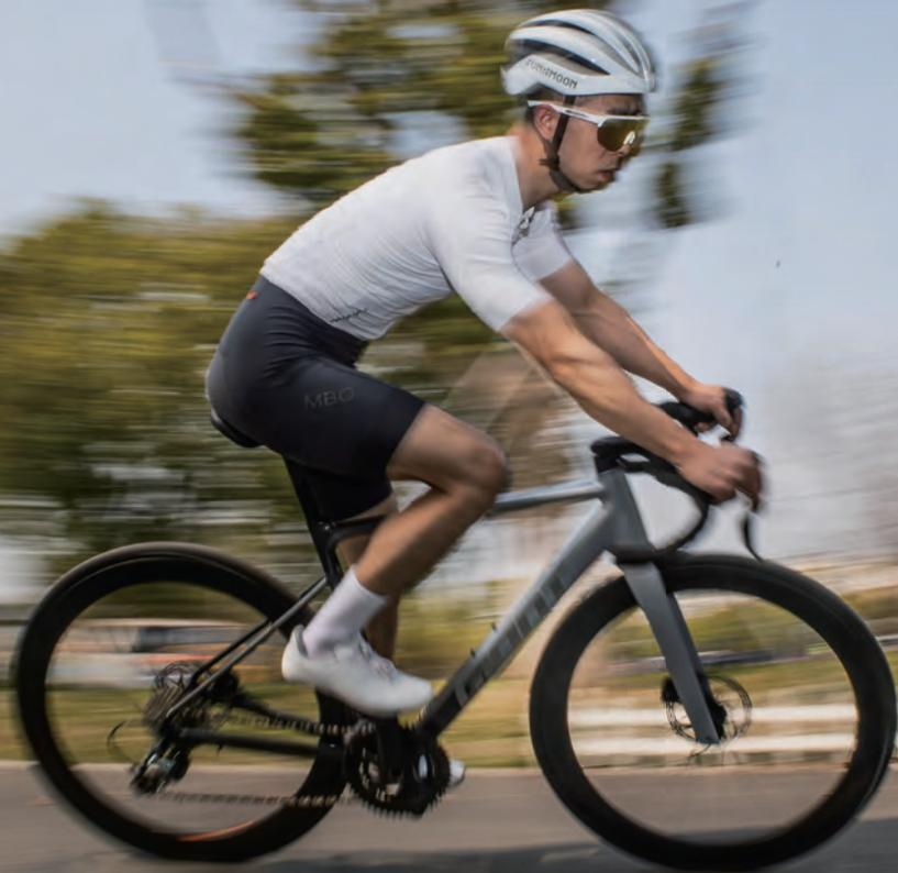
PCR LTD 搭配二代鲑鱼头 CD 线拉油碟，其整体外观较上一代更为简洁。但在实际测试中，这套线转油系统的刹车力度略有欠缺，相比纯油碟，其制动力度稍显不足。
