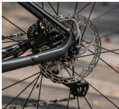
刹车手把选用禧玛诺 Tiagra，配备前后 160 mm 碟片，线拉油碟的后期升级空间很大
