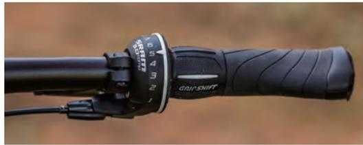
(右上) ARCHER P8 配备速联 X7 变速系统, 采用前 53T、后 11-32T 的齿比配置, 可以应对大部分通勤平路的需求。在面对长陡坡时, 若 ARCHER P8 能搭配 34T 双盘, 性能将更上一层楼
