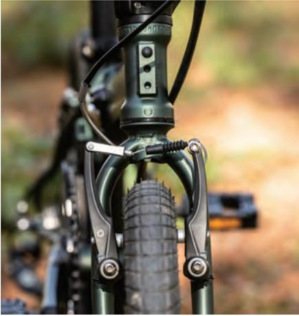
(左上) 在制动系统上, ARCHER P8 搭配 V 夹, 能有效应对复杂路况下的刹车制动
