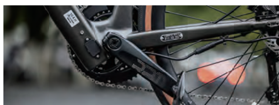
▲ F62 RS600 pro 采用一体把和隐藏式设计的操控平台，使走线显得格外简洁。同样，在下叉走线的充电口位置，电线也排列得很整齐。
