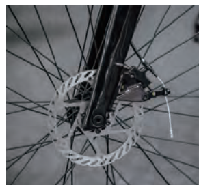
▲ 整车配备的普诺肯线拉油碟，以可靠性好、质量（重量）轻、外形美观、安装方便等优点而著称。
