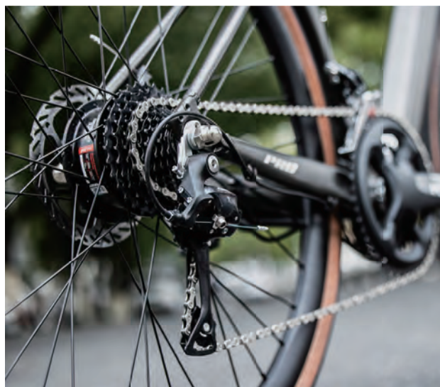
▲ 整车配备的普诺肯线拉油碟，以可靠性好、质量（重量）轻、外形美观、安装方便等优点而著称。
