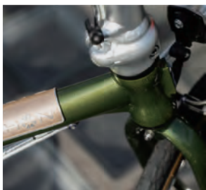
▲ 超级单梁与竖管连接处的管材呈微扁状，这一独特设计使得骑行时路感更加稳健且舒适，面对复杂路况也能应对自如。
