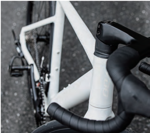
▲ 头管和前叉叉肩之间的缝隙饱满、平整。
